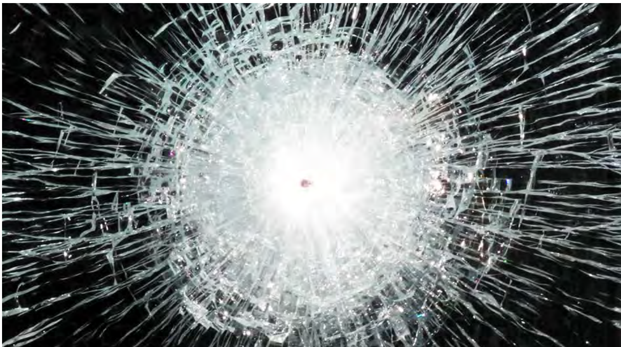
Glaslaminatprobe nach Beschuss.
