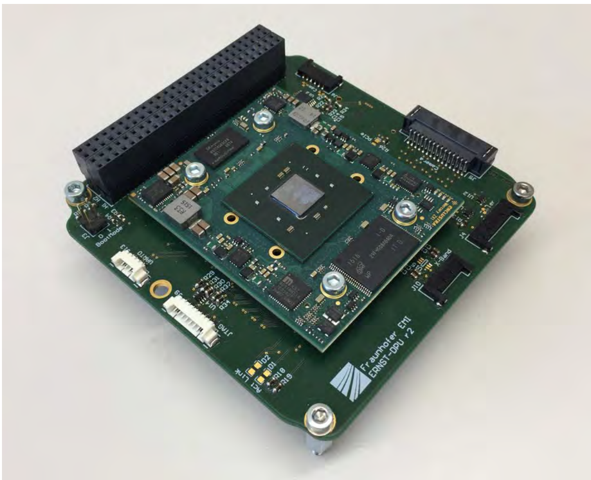
Datenverarbeitungseinheit mit FPGA-Technologie.
