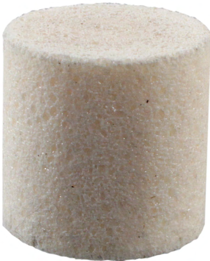
PBX-Probe für die Materialcharakterisierung.
