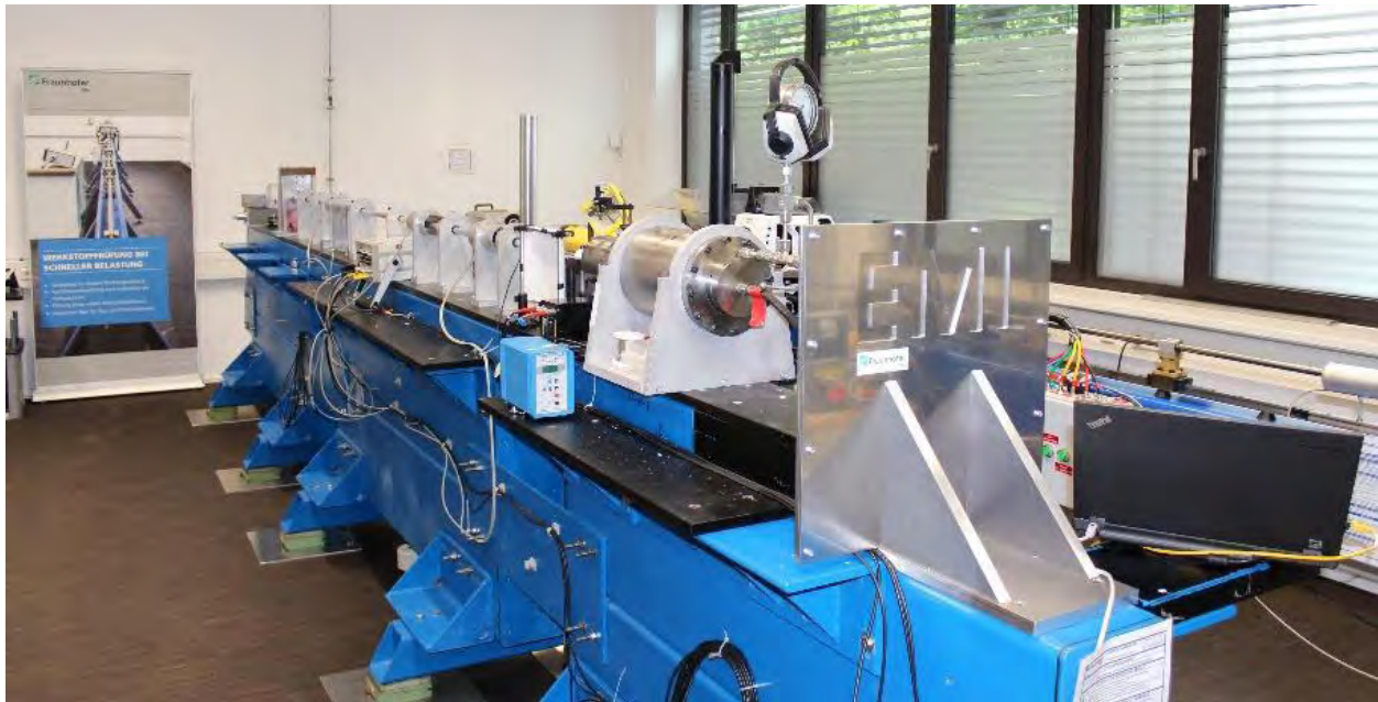
Der Hopkinson Bar am Fraunhofer EMI.
