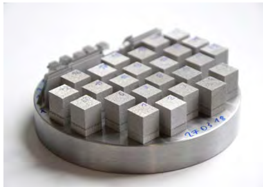
Additiv gefertigte Versuchskörper aus Schwermetall (Wolfram) für die Untersuchung optimierter Prozessparameter.
